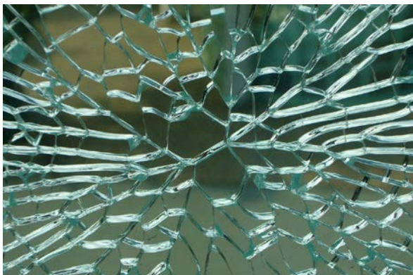
Illustration 3: image de casse VT avec structure en forme de papillon
